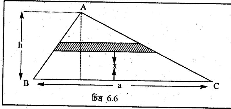
ত্রিভুজাকার পাতটিকে BC বাহুর সমান্তরালে সরু সরু ফালিতে ভাগ করা হল। BC থেকে  $x$  দূরত্বে  $dx$  প্রস্থের একটি ফালির দৈর্ঘ্য হবে  $\frac{a(h-x)}{h}$ । পাতের একক ক্ষেত্রের ভর  $\sigma$  হলে ফালির ভর হল  $\frac{\sigma a(h-x)}{h} dx$ । BC অক্ষ থেকে এই ফালিটির সব কণাই সম দূরত্বে আছে। অতএব এই ফালিটির জড়তা ভ্রামক =  $\frac{\sigma a(h-x)}{h} x^2 dx$ । সম্পূর্ণ পাতের জড়তা ভ্রামক
