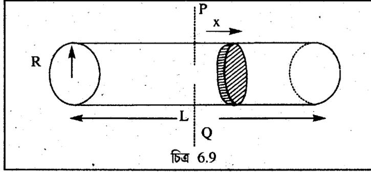
চিত্র অনুযায়ী PQ অক্ষে বেলনের জড়তা ভ্রামক নির্ণয় করতে হবে। বেলনকে তার নিজের অক্ষের অভিলম্বে অনেকগুলি সরু গোলাকার পাতের ভাগ করা হল। এরকম যে কোনও একটি পাতের বেধ  $dx$  এবং PQ থেকে দূরত্ব  $x$  হলে পাতের ভর  $m = \pi R^2 dx \rho$  (বেলনের ঘনত্ব  $\rho = \frac{M}{\pi R^2 L}$ )
