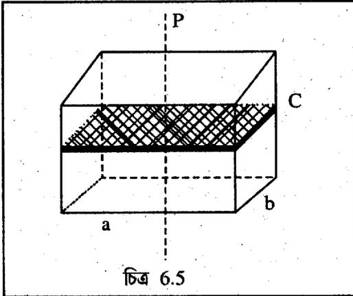
এবং c। c বাহুর সমান্তরাল কেন্দ্রগ PQ অক্ষের সাপেক্ষে জড়তা ভ্রামক নির্ণয় করতে হবে। বস্তুটিকে PQ অক্ষের অভিলম্বে অনেকগুলি পাতলা আয়তাকার পাতে ভাগ করা হল। PQ অক্ষের সাপেক্ষে যে কোনো পাতের জড়তা ভ্রামক =  $\frac{\text{পাতের ভর}}{12} (a^2 + b^2)$  (6.19নং সমীকরণ অনুযায়ী)। অতএব বস্তুটির ভর M হলে PQ অক্ষের সাপেক্ষে বস্তুটির মোট জড়তা ভ্রামক
