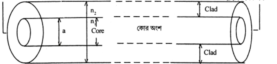
চিত্র 12.1 : একটি আলোক তন্তু।
