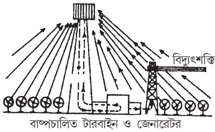
চিত্র ১৭.৮ : সৌরশক্তির সাহায্যে বিদ্যুৎ উৎপাদন কয়েক হাজার আয়না ৩০০ ফুট উচ্চ টাওয়ারের উপর বসানো বয়লারে সূর্যরশ্মি কেন্দ্রীভূত করে বাষ্প উৎপাদন করে। এই বাষ্প ব্যবহার করে বিদ্যুৎ উৎপাদন করা হয়।
