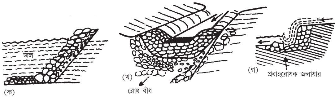
চিত্র ১৮.২ : (ক) জলের অনিয়ন্ত্রিত প্রবাহ নিবারণের জন্য জলনিষ্কাশন ব্যবস্থা।
